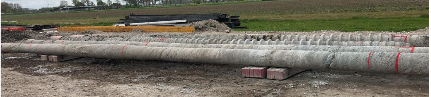
FIGUUR 26 GETROKKEN PALEN OOSTWOUD, PAALKOP AAN DE LINKER ZIJDE
